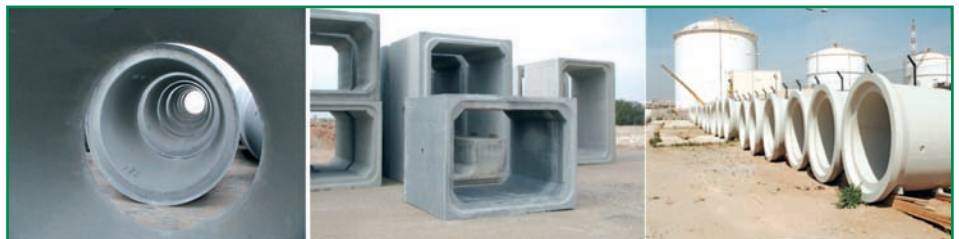
[Fig. 1].- Acopio de conductos de hormigón.
