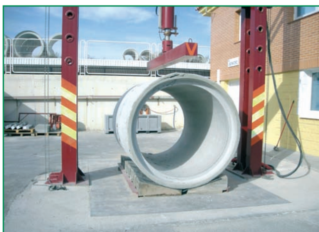
[Fig. 3] .- Ensayo de tres aristas de un tubo de hormigón circular.
