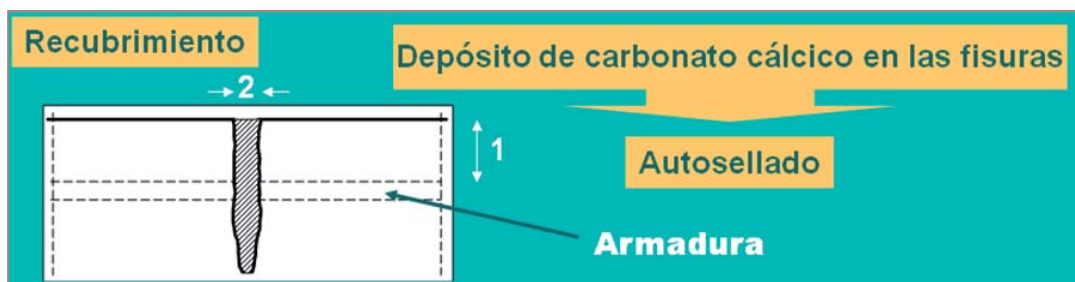
■ Figura 4. Efecto de relleno o sellado de las microfisuras del hormigón.
