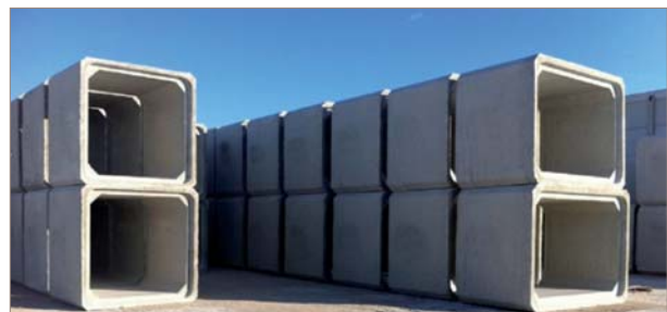
■ Figura 9. Galerías de hormigón armado.
