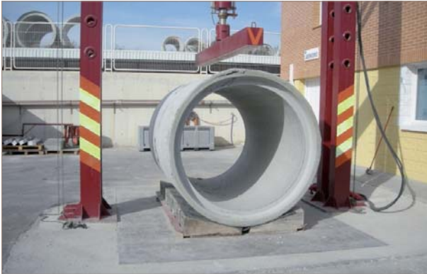
■ Figura 3. Ensayo de tres aristas de un tubo de hormigón circular.
