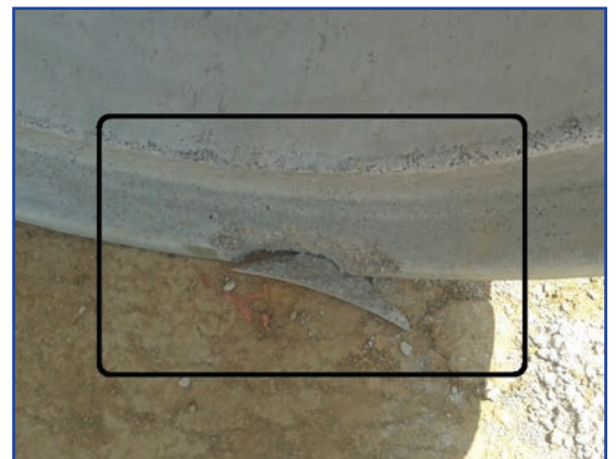
Figura 9. Maquinaria generalista de obra y tubo con daños en la boquilla
