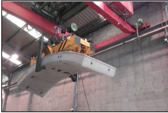
A través de un sistema automático de ventosas se transportan las dovelas hasta la volteadora
