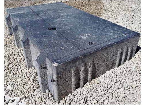
9. Suministro de 2.500 m 2 de losas de 50X29X12 cm con distanciador de 2 cm y tratamiento durobrill para Avda. del Galeón en Magalluf (Mallorca). Fabricante PAVIMENTS LLOSETA.
