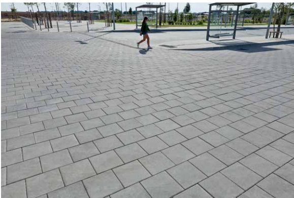
8. Estación de Montpellier (Francia) con el pavimento técnico VS5® (30x20x10 cm) en color "black". Un adoquín capaz de soportar grandes cargas de tránsito y que cuenta con unas ranuras de 8 mm de profundidad que producen un efecto de pinzamiento en el lecho de arena, creando así un efecto de prevención de posibles desplazamientos. Fabricante BREINCO.
