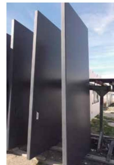
Paneles negros con rotura de puente térmico completo listos en fábrica para envío a obra en Suiza. (Foto cortesía de Indagsa)
