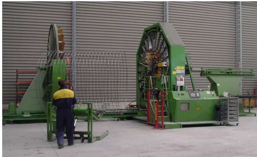
Figura.- Fabricación de armaduras
