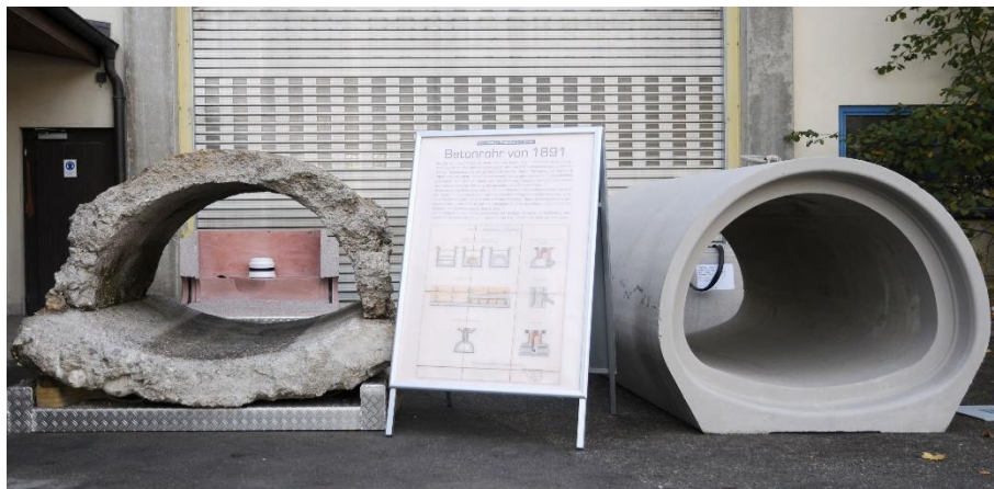
Figura.- Estado de un tubo fabricado e instalado en 1891. Fuente: HABA_Maulprofil
