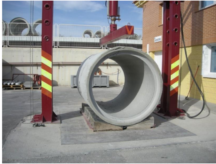
Figura.- Ensayo rotura de las tres aristas para evaluar el comportamiento mecánico de los tubos de hormigón
