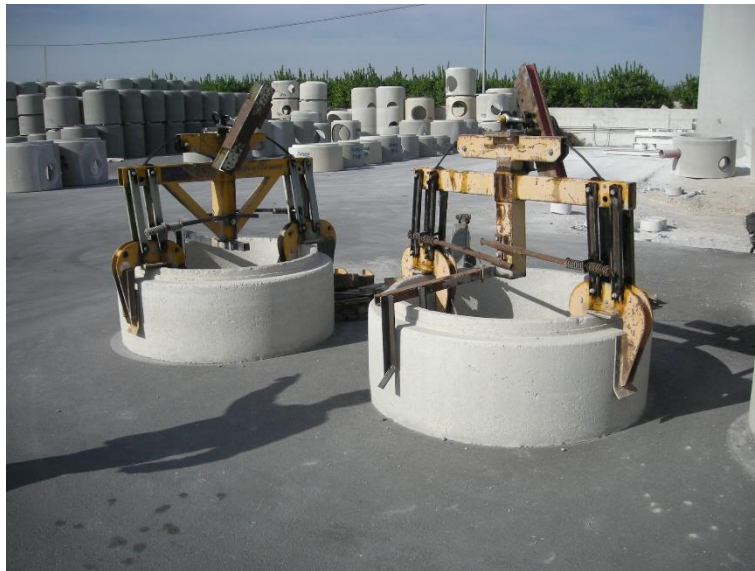
Figura.- Pinzas de manipulación de anillos prefabricados de hormigón
