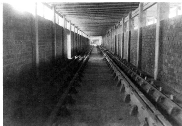
Fig. 3.- Primeras bancadas de elementos prefabricados pretensados en España.
