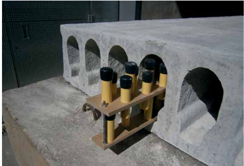
Figura 5.- Colocación de encapsulado con materiales de cambio de fase (PCM's) dentro de los alveolos de una placa, para mejora de la eficiencia energética.
