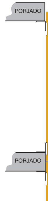
Detalle de panel de cara inferior a superior de forjado
