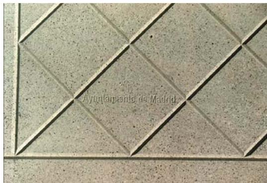
**Pulido.** Con este tratamiento mecánico se obtienen unos paneles con un aspecto totalmente liso.
