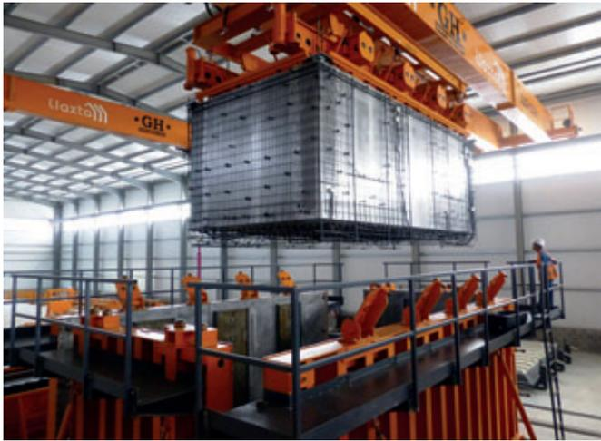
Fig. 7: El núcleo preparado con armadura, piezas montadas, conexiones de agua y corriente se coloca en el encofrado de módulo.
