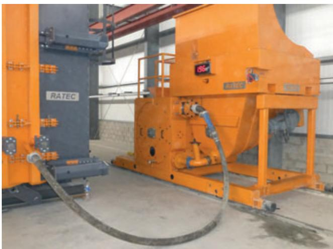
Fig. 8: Conexión de la bomba al encofrado
