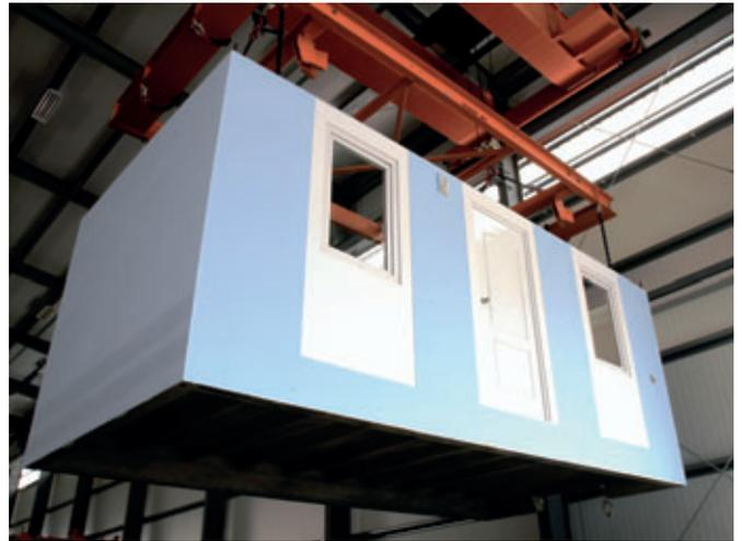
Fig. 14: El módulo terminado es transportado a obra listo para su montaje
