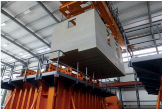
Fig. 11: Con la ayuda de travesaños especiales y una grúa de 12,5 t, el módulo de ambiente es transportado para su procesamiento posterior
