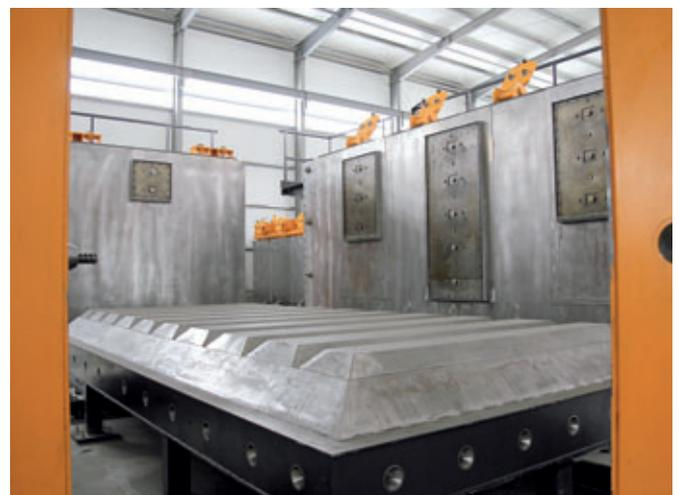
Fig. 6: El encofrado de módulo abierto. Los elementos para huecos como ventanas y puertas están fijados al encofrado exterior.
