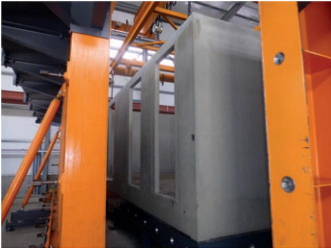
Fig. 9: Tras retirar el «núcleo contraíble» ya se puede abrir el encofrado exterior
