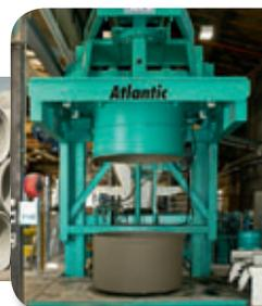
**ATLANTIC** Producción eficiente de pozos y de tubos con un diámetro de hasta DN 2.000 mm con la máxima calidad y un elevado volumen de producción.
