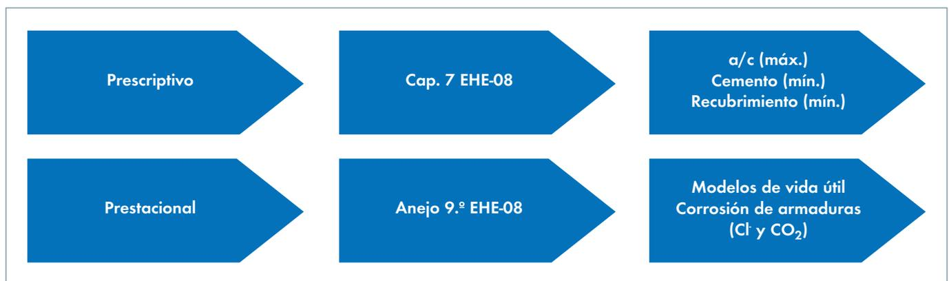
Fig. 1a y 1b: Métodos para la evaluación de la vida útil de una estructura de hormigón según EHE-08
