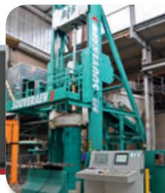
**SOUVERAEN** Moderna tecnología para la producción de tubos de hormigón con un elevado volumen de producción y máxima calidad.
