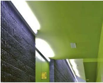
La iluminación interior se resuelve en mayor medida con “líneas de luz”; luminarias de lámparas fluorescentes en montaje continuo lineal, dibujando en el aire la dirección de las circulaciones principales o el eje de curvatura de las bóvedas-colinas.
