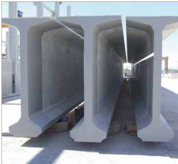
■ Foto 6. Un perfil muy habitual en la industria: las secciones 'doble T' para estructuras de puentes.
