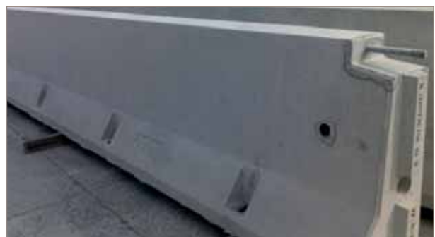
■ Foto 5. La nueva barrera de seguridad 'New Jersey', construida con plásticos y material reciclado a partir de neumáticos fuera de uso, supone una mejora respecto a los sistemas de protección convencionales porque absorbe mayor energía del impacto y reduce las emisiones de CO 2 generadas durante el proceso de fabricación.
