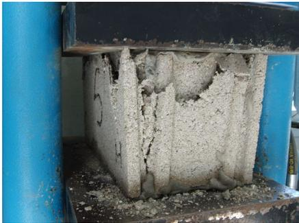
Fig. 9: Ensayo de bloque reciclado.
