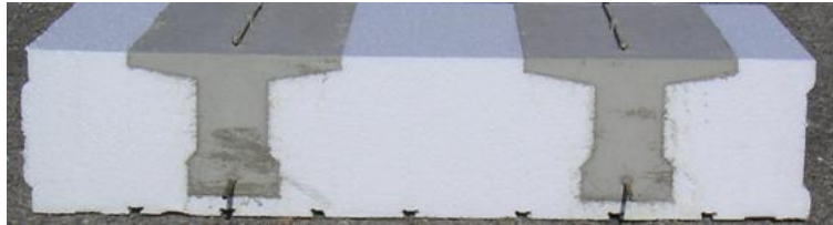
Figura.- Tipo de placa formada por dos nervios de hormigón armado en forma de doble "T" unidos por una pieza de poliestireno expandido a la que se añade en obra una losa de hormigón vertida in situ
